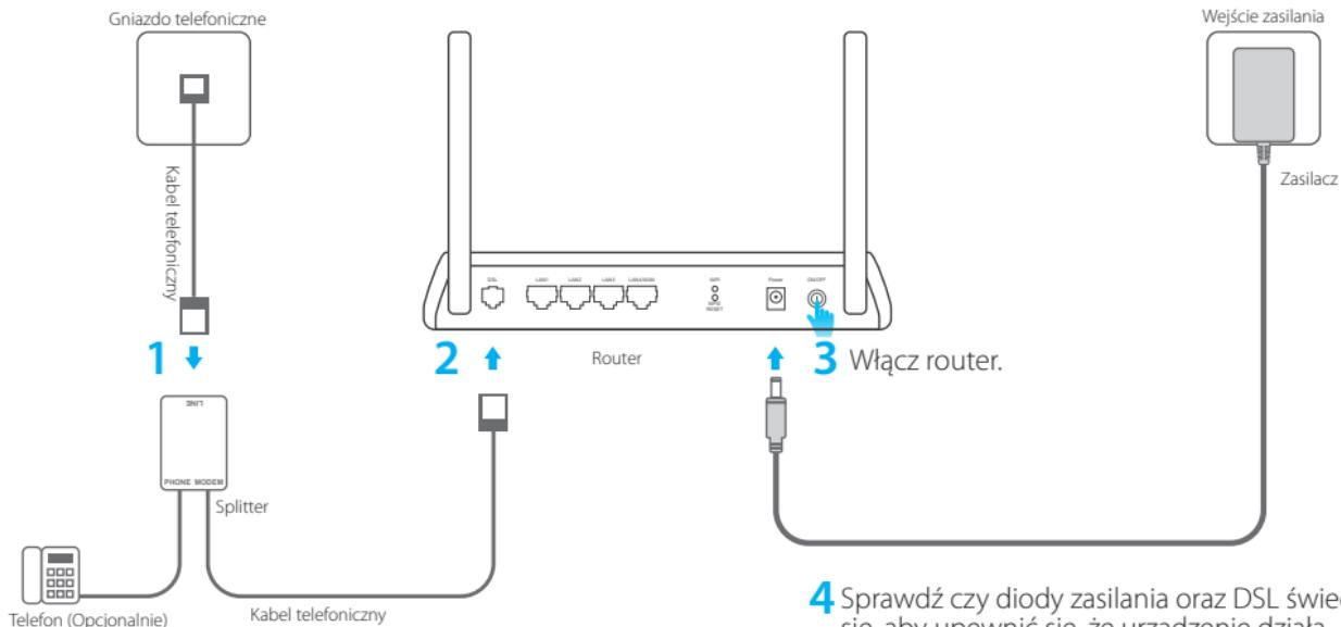
**4** Sprawdź czy diody zasilania oraz DSL świecą się, aby upewnić się, że urządzenie działa prawidłowo.
